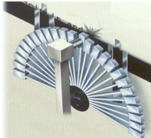
Dieses Bild zeigt den Druckvorgang eines Typenraddruckers
